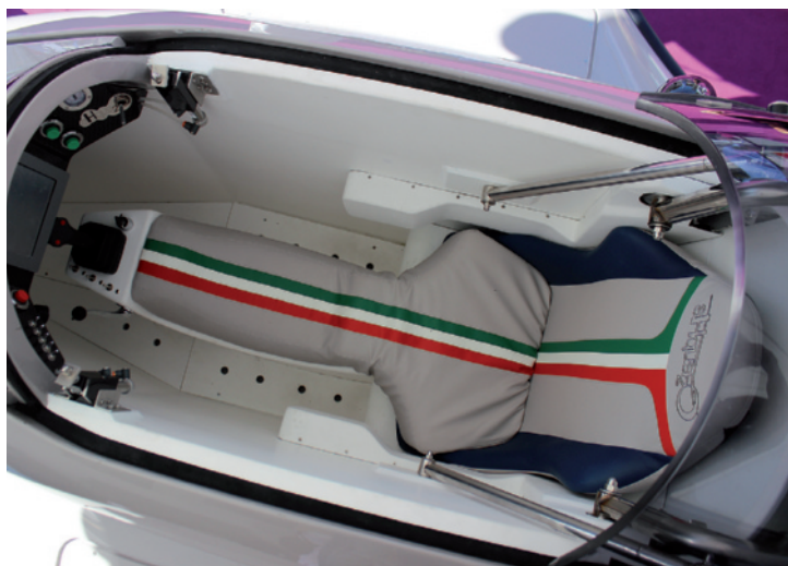
Il timone e le pinne subacquee sono comandate da una cloche, di derivazione aeronautica
