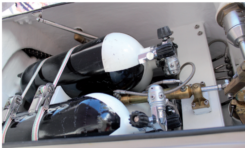
aHqua_0 presenta un impianto immersione/emersione acqua/aria integralmente gestito attraverso flussi d'aria compressa
